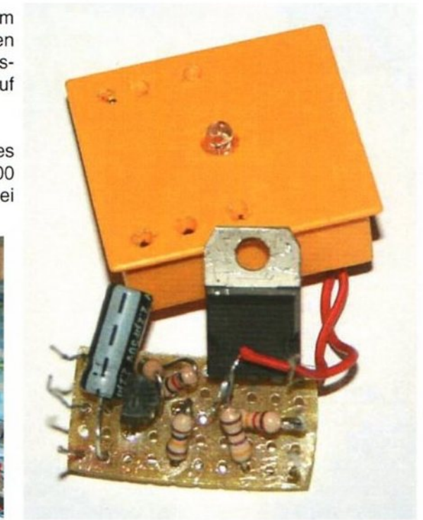
Die Schaltung, aufgebaut auf einem Stück Lochrasterplatte
